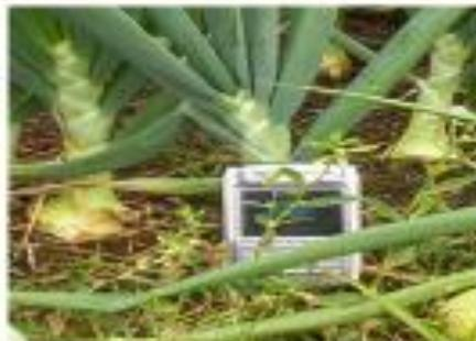
**Instrumento de uso agrícola para medir temperatura, humedad y frecuencia de aportación de agua según el cultivo.**
